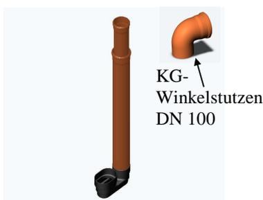
Er verhindert das Aufwirbeln der Bodensedimentation und verbessert somit die Speicherwasserqualität. Durch seine teleskopartige Ausführung kann man ihn an verschiedene Filterausführungen und Tankgrößen problemlos anpassen, indem man das Teleskop auf die benötigte Länge verschiebt und mit einer selbstschneidenden Schraube arretiert. Ebenso empfiehlt sich die Befestigung am Filterauslauf per selbstscheidende Schraube.
