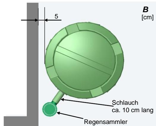
**Achtung: Um Frostschäden zu vermeiden, Behälter vor Wintereinbruch entleeren und Auslaufhahn entfernen. Am Regensammler ist der Wintereinsatz einzusetzen!**
