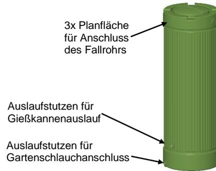
Der obere Auslaufstutzen der Regensäule ist als Gießkannenauslauf positioniert. Die untere Buchse dient als Gartenschlauchanschluss. Bei der Montage der Ausläufe muss man die Gewinde mit Teflonband o. ä. abdichten und anschließend handfest anziehen.
